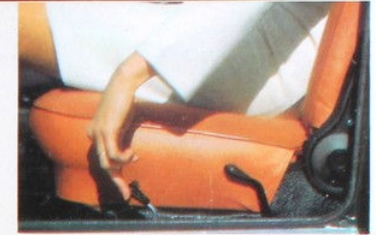
Deux manettes placées sur le côté des sièges AV permettent leur réglage en position (1) et l'inclinaison du dossier (2).
